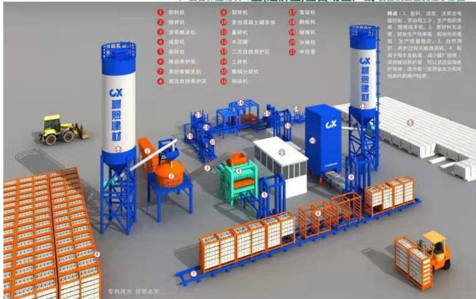
→ 复合保温砌块 C型(经济型)全自动生产线设备及工艺流程示意图
