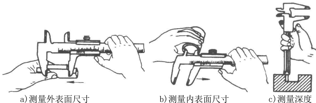
图 1—21 用游标卡尺测量工件
