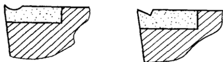
图 a—25 断屑槽的两种形式
